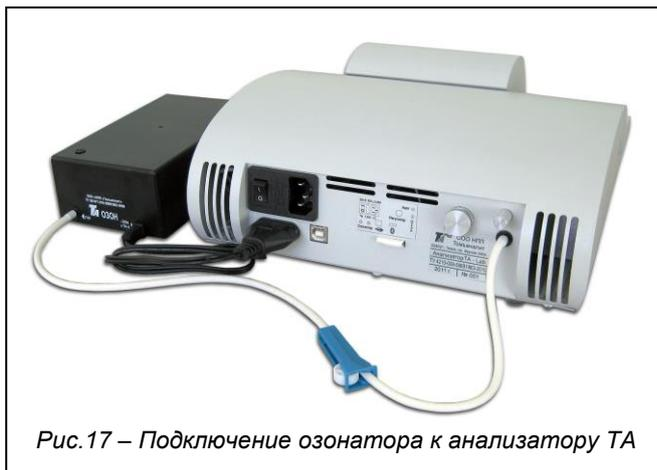
Рис.17 – Подключение озонатора к анализатору ТА
