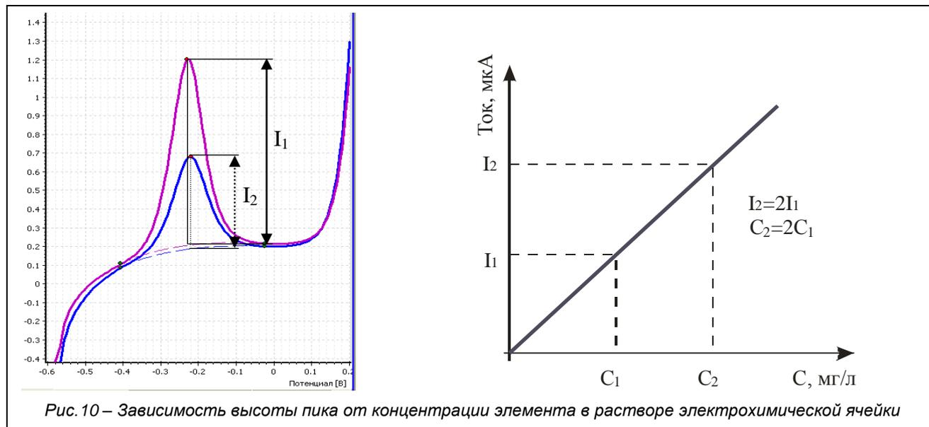
Рис. 10 – Зависимость высоты пика от концентрации элемента в растворе электрохимической ячейки
