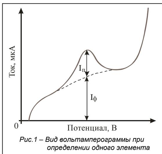
Ток, вызванный электрорастворением концентрата определяемого элемента с поверхности электрода, на вольтамперограмме имеет вид пика. Положение пика на оси потенциалов, т.е. потенциал пика, характеризует природу определяемого вещества, а высота и площадь зависят от его концентрации в растворе. Таким образом, вольтамперограмма позволяет одновременно получить качественную и количественную информацию о веществах, присутствующих в анализируемом растворе.
