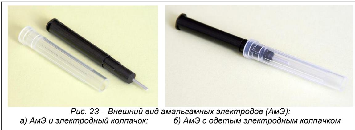
4.2.2 АмЭ представляет собой полимерный стержень с запрессованной серебряной проволокой диаметром 1,1 мм, длиной (7-8) мм (рис.24). Рабочей поверхностью электрода является серебряная проволока, покрытая амальгамой серебра. Для образования амальгамы на серебряную проволоку наносят пленку ртути. После нанесения ртути на поверхность серебра за счет взаимной растворимости ртути и серебра начинается процесс образования амальгамы серебра на поверхности АмЭ.
