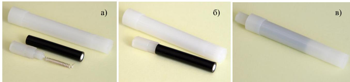
Рис. 21 – Внешний вид хлорсеребряного электрода (ХСЭ) и его колпачка:
