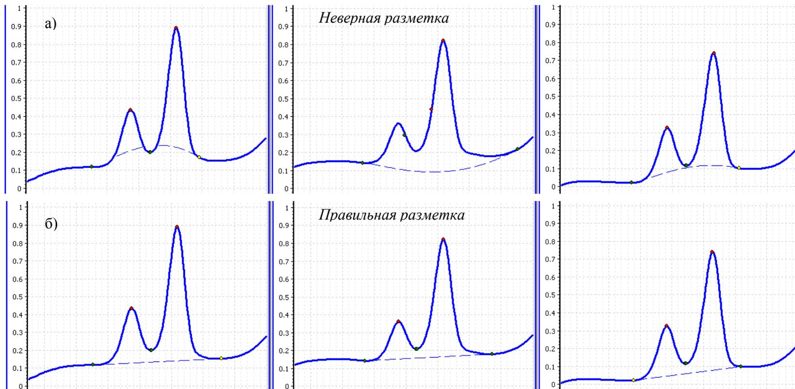
Рис.28 –Разметка вольтамперограмм пробы: а) неверная; б) правильная.
