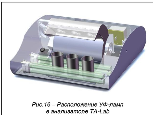
Рис.16 – Расположение УФ-ламп в анализаторе TA-Lab
