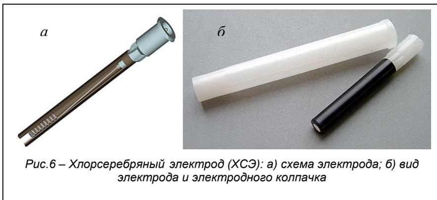
Рис.6 – Хлорсеребряный электрод (ХСЭ): а) схема электрода; б) вид электрода и электродного колпачка
