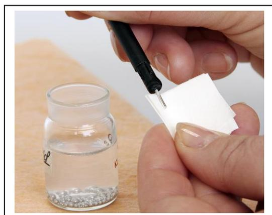
4 Ртуть на электроде растирают фильтровальной бумагой (свернутой в 2-4 раза и смоченной бидистиллированной водой) по всей поверхности серебра для равномерного распределения ртути.
