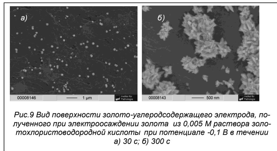
Углеродсодержащие электроды для анализатора TA-Lab содержат только 30 % углерода, который равномерно распределен в объеме электрода, поэтому при осаждении золота на его поверхность равномерной золотой пленки не образуется. Золото осаждается в виде микро/наночастиц, которые формируют ансамбль золотых микроэлектродов. На поверхности электрода может быть расположено
